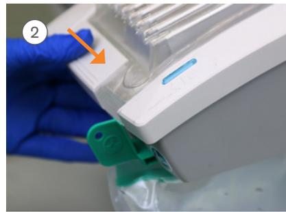
Para substituir o saco de recolha de fluidos, **pressione a lingueta** do InterCooler **para soltar a cassete**
