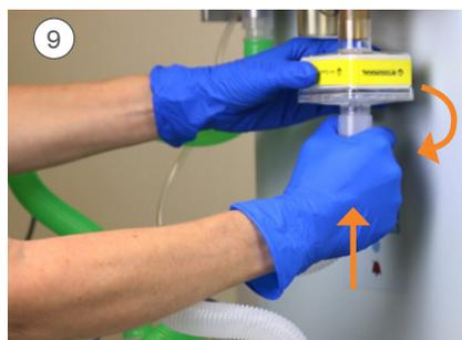
**Ligue a outra extremidade do tubo de retorno ao ventilador**. Se for necessária **filtração**, utilize o filtro de 7 dias **Air-Guard Clear 7**
