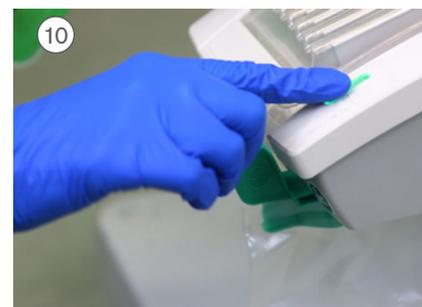
**Prima o botão de alimentação para ligar o InterCooler**. O botão irá **iluminar com a cor verde** se o sistema estiver bem instalado e a **funcionar corretamente**
