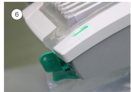
O botão irá **iluminar** com a cor **verde** se o sistema estiver bem instalado e a **funcionar corretamente**
